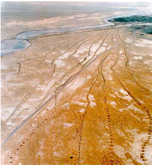
Système de khattara près de la vallée du Tafilalet à l'est des Hauts Atlas. L'eau collectée est utilisée pour irriguer l'oasis visible en arrière plan. Tirée de http:// www.francoravelli.it/.../ 1987.htm
